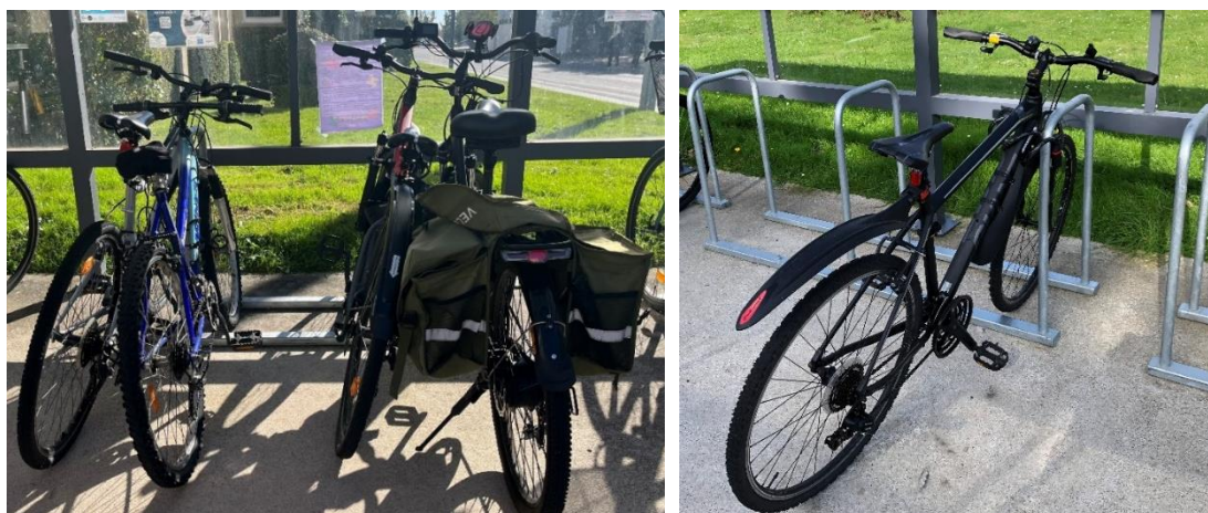
Vélos accrochés à des arceaux espacés de 82,5cm sur le Campus 2 (gauche) et râtelier d'arceaux installé sur le Campus 2 (droite)
