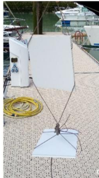
Plaques installées dans les marinas : (a) avant immersion, (b) après trois mois d'immersion, (c) nouveau système de plaque.
